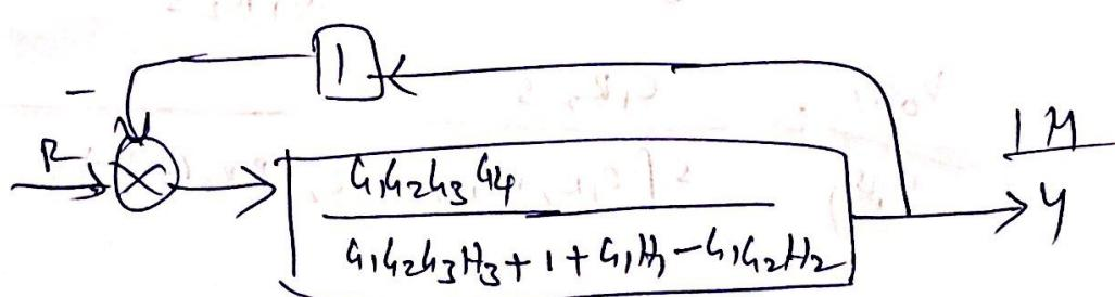
$$\frac{y(s)}{R(s)} = \frac{G_1 G_2 G_3 G_4}{1 + G_1 H_1 - G_1 G_2 H_2 + G_1 G_2 G_3 H_3 + G_1 G_2 G_3 H_4} \frac{D(s)}{s}$$
