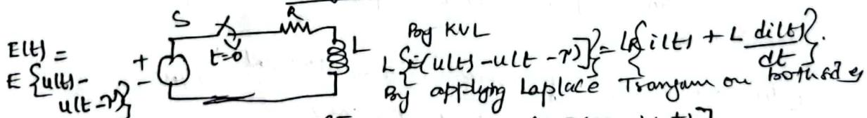
$$\frac{E}{s} - \frac{E}{s} e^{-sT} = R \bar{i}(s) + L \left[ s \bar{i}(s) - i(0^+) \right]$$
